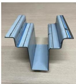
El plegado CNC es una técnica que nos permite plegar chapas metálicas con precisión y con la reducción de posibles errores ya que nuestras tecnologías nos permiten visualizar, antes de la elaboración del producto, el resultado final gracias al uso del CAD 3D.
